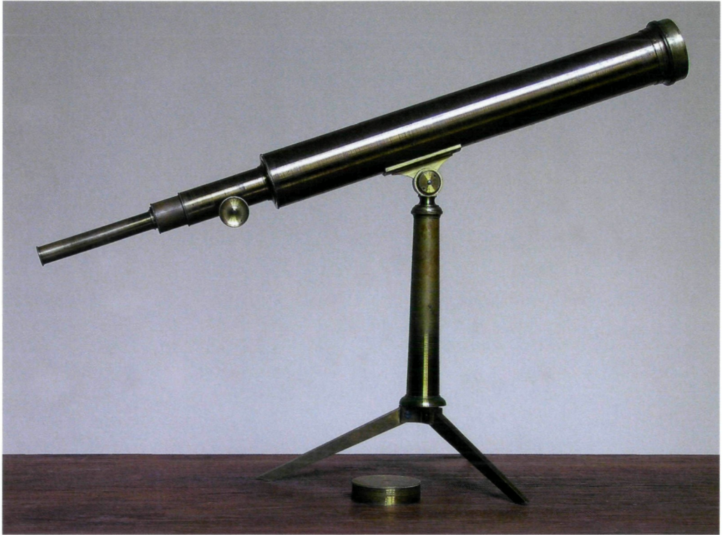
Abb. 2: Dreizölliges dialytisches Fernrohr von Plössl (Sammlung Kotlan).
