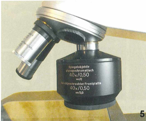
Abb. 5: Riesenberg-Spiegel, Carl Zeiss Jena, 40/0,50, montiert an einem Leitz SM-Lux HL, mit zwei Linsenobjektiven passender Abgleichlänge. – Abb. 6: Cooke-Spiegel 40× (NA 0,57) und katadioptrisches Spiegelobjektiv von Zeiss 16/0,32, montiert an einem Leitz Dialux.
