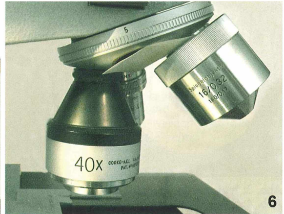
Abb. 5: Riesenberg-Spiegel, Carl Zeiss Jena, 40/0,50, montiert an einem Leitz SM-Lux HL, mit zwei Linsenobjektiven passender Abgleichlänge. – Abb. 6: Cooke-Spiegel 40× (NA 0,57) und katadioptrisches Spiegelobjektiv von Zeiss 16/0,32, montiert an einem Leitz Dialux.
